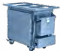
11527 Etuve électrique petit modèle 220/230 V - 16 A monophasé - 2 kW Température maxi 150°C en 30 min - Combiné adaptable pâtisserie ou gastronorme 1/1. Fourni avec 5 grilles pâtisseries 60 x 40 cm. Espace entre les grilles : 7 cm. Ext. : L 89 ; P 50,5 ; H 73 cm. Int. : L 60 ; P 40 ; H 45,5 cm
