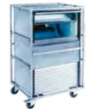
27089 Machine à glaçons Int. : L 67 x P 56 cm H 98 cm Ext. : L 72 x P 66 cm H 116 cm Porte glissant vers l'intérieur - 775W 30 mn de mise en marche et refroidissement Cycle de 15 mn = 55 glaçons Production de 75 Kg /24h Stockage 37 Kg - Poids 60 Kg En complément : pelle à glaçons page 319
