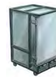
0409 / 0229 Etuve morice mixte Livrée avec 8 grilles. Espace entre les grilles : 8 cm. Ext. : L 74 ; l 96 ; H 135 cm. Int. : L 60 ; l 80 ; H 95 cm. 143 Kg Gaz (0229) : 1 bouteille de gaz butane (20 Kg). Détendeur de 28 mbar. Equipée d'une sonde thermostatique pour le gaz, les rampes se coupent à 180°C et se rallument à 160°C. Electrique (0409) : 220 V / 16A monophasé - 4,5 kW. Répartis entre 2 prises (1,5 kW et 3 kW)
